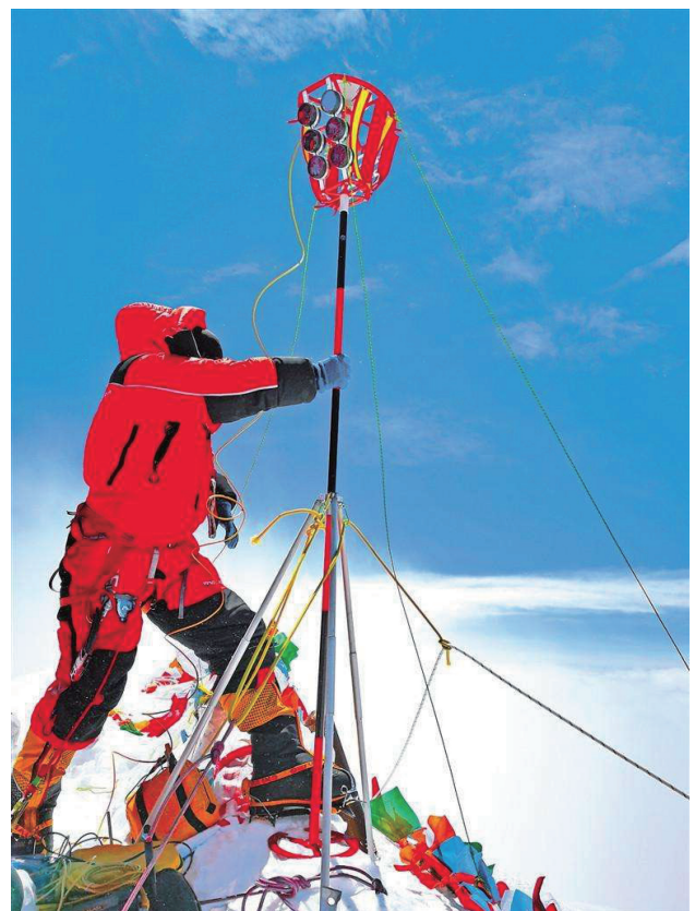
图 6 2020 珠峰高程测量队员在峰顶竖起测量觇标
