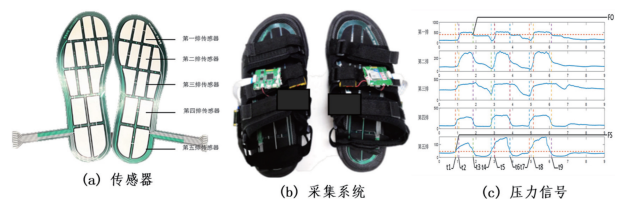
图 13 柔性阵列传感器进行步态周期检测
